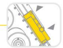
Ferramenta correctora de cantoneira Mec. ou Hid. (opcional) Angle bending guide rolls Mec. or Hyd. (optional) Herramienta correctora de ángulo Mec. ó Hid. (opcional)
