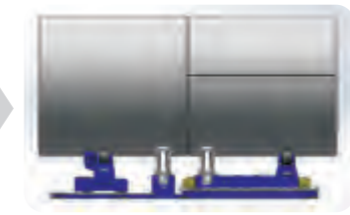
C、1+1组对完成 C、1+1 finish fit up
